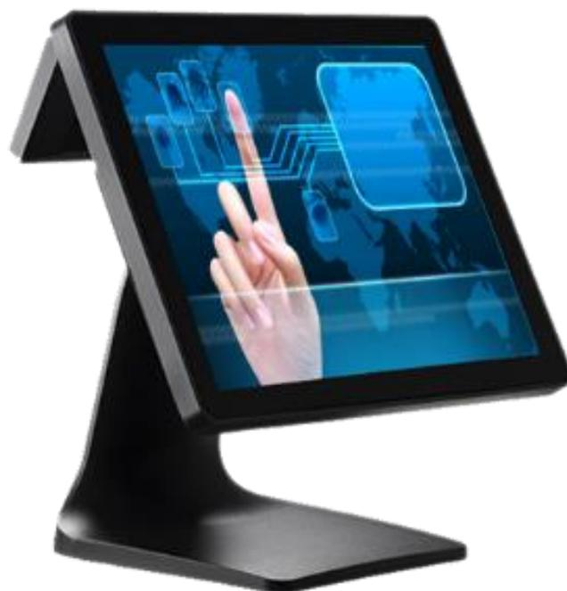
Terminal equipado com ecrã plano tátil 15" capacitivo e estrutura de alumínio.
